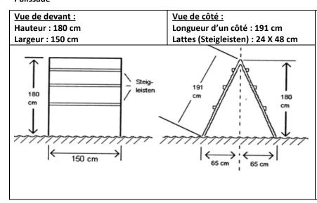
La palissade est composée de deux parties fixées solidairement d'une largeur de 150 cm et d'une hauteur de 180 cm. Au sol, ces deux parties sont écartées de telle façon que le sommet se situe à 180 cm. Toute la palissade doit être recouverte d'un revêtement antidérapant. Dans la partie supérieure des côtés, sont disposées 3 lattes (24X48 cm), pour faciliter le franchissement.
